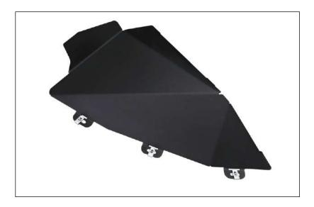
28. Install U-nuts (pos. F) to the flaps (pos. 4, 5).
