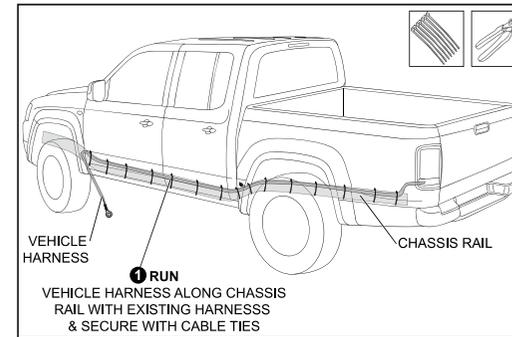
Diagram 4 - RUN HARNESS ALONG CHASSIS RAIL
